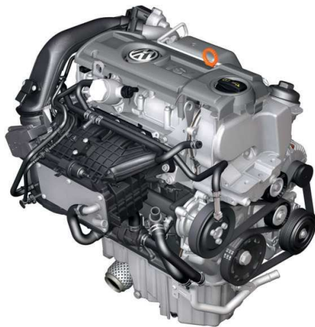
Volkswagen 1.4l TSI / 4 cilindros gasolina Desempenho: 180hp
