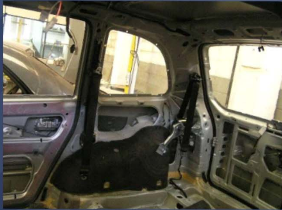
CARRO COM COMPONENTES DE INTERIOR DESMONTADO PARA APLICAÇÃO DO MATERIAL BALÍSTICO
