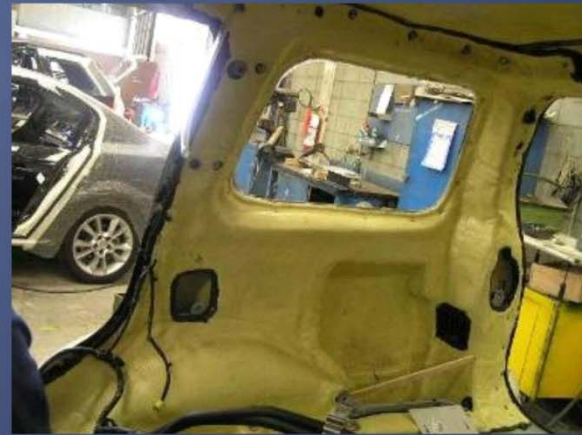
APLICAÇÃO DE PLACAS DE ARAMIDA (MATERIAL BALÍSTICO)
