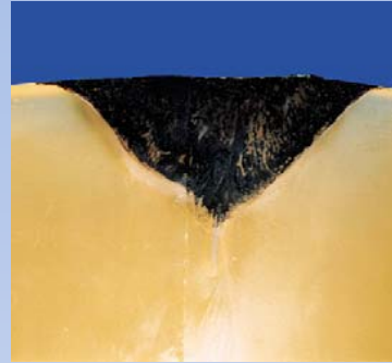
CARBONIZAÇÃO DA FRENTE DE FLUXO OU EFEITO DIESEL
