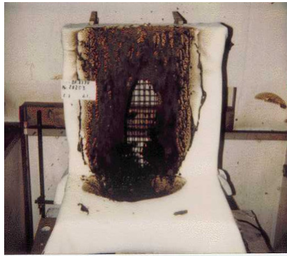
Surfactante não Adequado Perda de Massa >120 g
