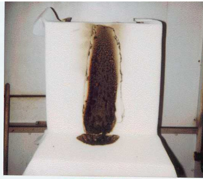
Surfactante Adequado: TEGOSTAB® B8239, Perda de Massa << 60 g
