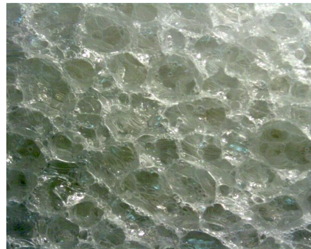
“Células fechadas” que caracterizam uma espuma viscoelástica pneumática. (Bayfit 13MC20 + Desmodur M 100)
