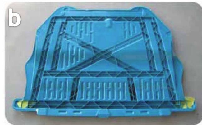
Figura 2 - Peça após desmoldagem. a- face voltada para a estrada. b- face voltada para o interior do veículo
