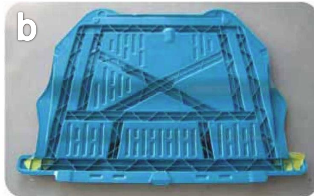
Figura 2 - Peça após desmoldagem. a- face voltada para a estrada. b- face voltada para o interior do veículo
