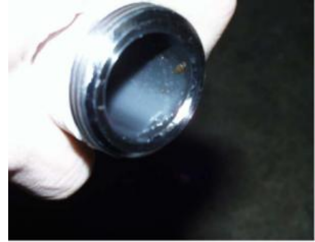
Há adesão de parafina para acessórios de metal não revestido
