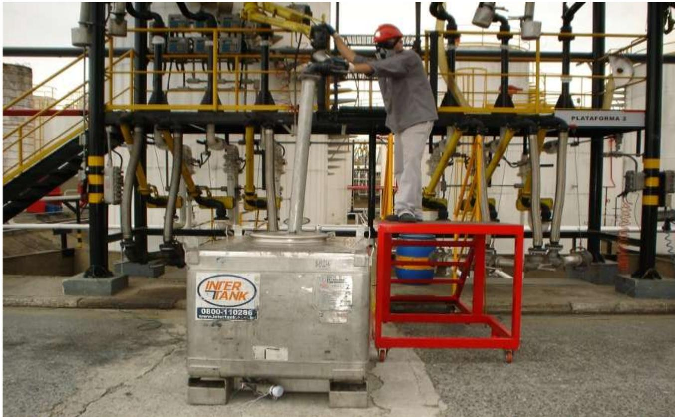
**Na foto mostrada acima um contentor metálico em aço inoxidável está sendo carregado com tolueno, que é produto inflamável de baixa condutividade elétrica.**
