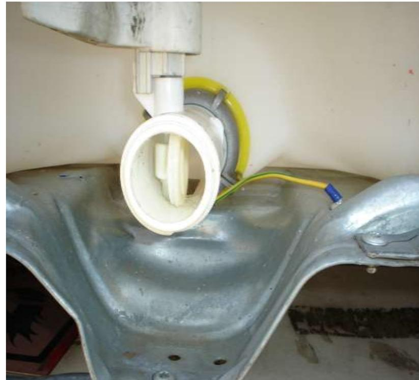
**Contentores de polietileno anti estáticos, com barreira contra permeabilidade, adequados para operar em área EX, possuem um dispositivo metálico localizado na válvula de fundo, com área de 0,00042 m<sup>2</sup>, por onde devem escoar as cargas eletrostáticas que se formarem no líquido durante o enchimento do IBC.**
