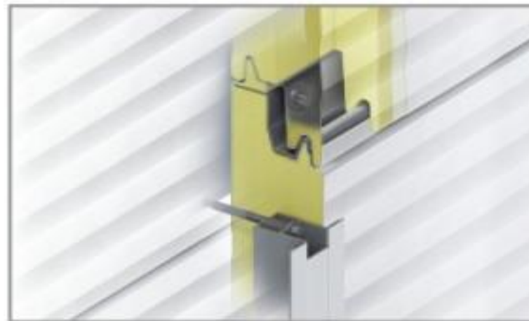
Detalhe de montagem
