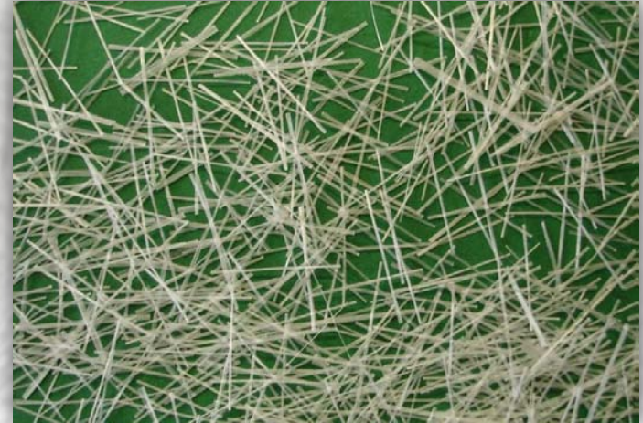
Reforço de concreto com fibra de vidro
