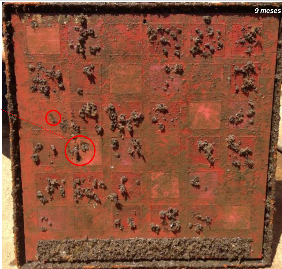
Danos mecânicos quando o "Siem Giant" foi movimentado no cais
