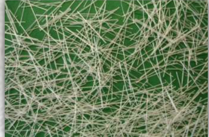
Reforço de concreto com fibra de vidro
